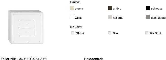
EDIZIO.liv - Wiser LED-Universaldimmer 1-Kanal - 1 dimmbarer Ausgang, 230 V AC - Für dimmbare Retrofit LED 150 VA (RC) / 60 VA (RL) - Für dimmbare Trafo (RC/RL) mit NV-Leuchtmittel (Halogen, LED) 300 VA - Mischlastbetrieb von elektronischen und konventionellen Transformatoren nicht möglich - Minimale und maximale Helligkeit einstellbar - Mit Steckklemmen - Beleuchtbar mit integrierter LED - 2 Tasten - SNAPFIX® Befestigungssystem - Anbauhöhe
